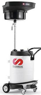
Aspirador de aceite usado de gravedad con depósito de 100 litros de descarga por presurización. Se descarga a través de una manguera de descarga de 1,5 m que presuriza la unidad a 0,5 bar (3.5 psi). Incluye válvula de seguridad para evitar sobre presurización.
