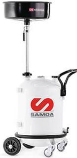
Aspirador de aceite usado de gravedad con depósito de 70 litros de descarga por presurización. Se descarga a través de una manguera de descarga de 1,5 m que presuriza la unidad a 0,5 bar (3.5 psi). Incluye válvula de seguridad para evitar sobre presurización.
