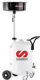
Aspirador de aceite usado de gravedad con depósito de 70 litros de descarga por bomba remota. Se descarga conectando la unidad a un kit de bomba de descarga de pared y mediante un conector hidráulico ubicado en la parte inferior del depósito.
