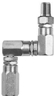
Rótula giratoria en "Z" para pistolas de grasa con conexión 1/4" BSP (MH). Equipada con rodamientos de bolas para una fácil articulación incluso a alta presión. Para obtener mejores resultados, utilice una rótula recta entre la bomba y la manguera de distribución y una rótula en "Z" entre la manguera y la pistola de control de grasa. Presión máxima de trabajo: 500 bar (7.150 psi).
