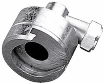
Boquillas de conexión rápida para engrasadores de tipo cabeza plana. Para utilizar con acoplamientos flexibles y en bombas manuales o neumáticas. Conexión deslizante y asiento de cierre por junta de caucho. Para engrasadores con cabeza de Ø22 mm. Todas las boquillas planas disponen de conexión 1/8" NPT (H). Máxima presión de trabajo 750 bar.
