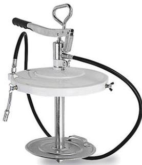
Bombas de alta presión para engrase construidas en acero para acoplamiento directo sobre bidones originales de grasa. La bomba, dotada de empuñadura de transporte, está provista de tapa con adaptador, plato seguidor y flexible de 1,5 m terminando en acoplamiento rígido con boquilla cuatro grapas con válvula (715 520).
