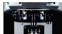
Cabezales automáticos Objetivos y penetradores 6 posiciones
