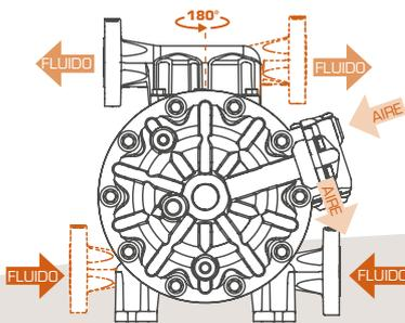
Las conexiones de entrada y salida son orientables, ofreciendo una mayor versatilidad durante la instalación de la bomba.
