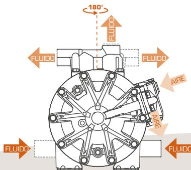
Las conexiones de entrada y salida son orientables, ofreciendo una mayor versatilidad durante la instalación de la bomba.
