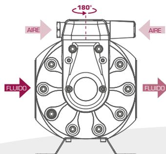
La conexión de entrada de aire es orientable, ofreciendo una mayor versatilidad durante la instalación de la bomba.
