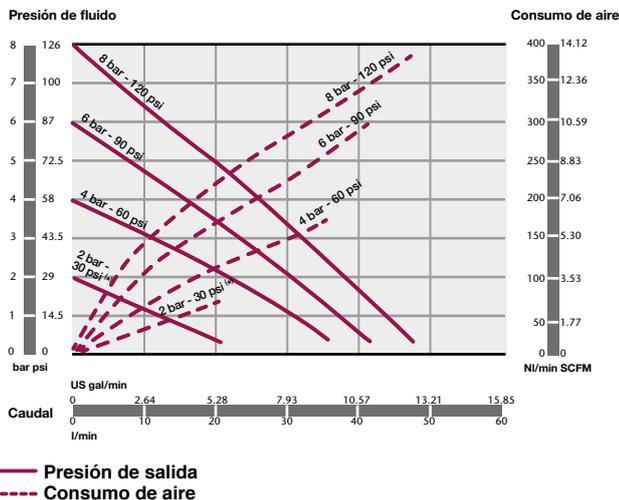
(\*) Curva de 2 bar realizada con bomba de membranas de PTFE (Teflon®).
