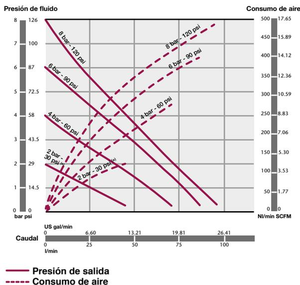
(\*) Curva de 2 bar realizada con bomba de membranas de PTFE (Teflon®).
