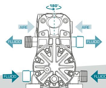
Las conexiones de entrada y salida son orientables, ofreciendo una mayor versatilidad durante la instalación de la bomba.
