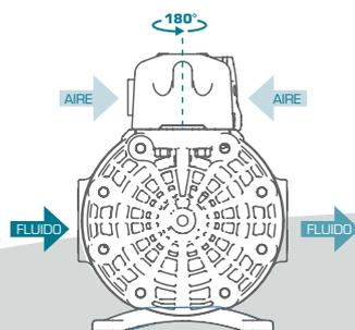
La conexión de entrada de aire es orientable, ofreciendo una mayor versatilidad durante la instalación de la bomba.
