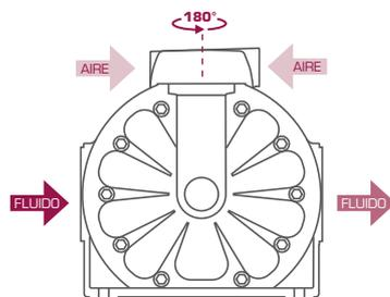
La conexión de entrada de aire es orientable, ofreciendo una mayor versatilidad durante la instalación de la bomba.
