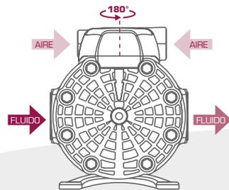
La conexión de entrada de aire es orientable, ofreciendo una mayor versatilidad durante la instalación de la bomba.
