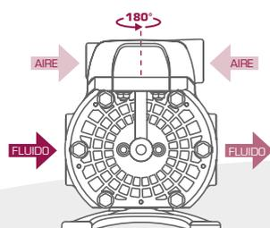
La conexión de entrada de aire es orientable, ofreciendo una mayor versatilidad durante la instalación de la bomba.
