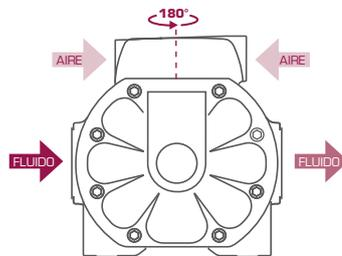
La conexión de entrada de aire es orientable, ofreciendo una mayor versatilidad durante la instalación de la bomba.
